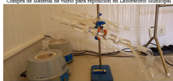
Implementación de sistema de Destilación para recuperación de Reactivos
